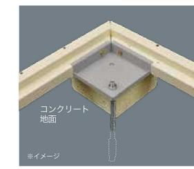
物置床下コーナー部分4コーナーに内アンカープレート設置。全ネジボルトとグリップアンカーエンジニアリングで地面に固定します。
