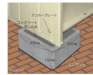
マスアンカーサイズ300mm×300mm×150mmで1ヶ所約45kg(4ヶ所で約180kg)。
